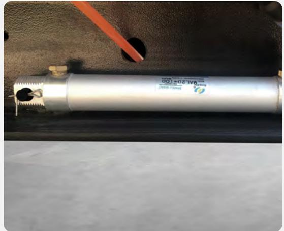
Seguridad con bloqueo neumático y trabas dispuestas cada 100 mm
