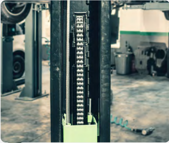
Sistema de seguridad de trabas mecánicas
