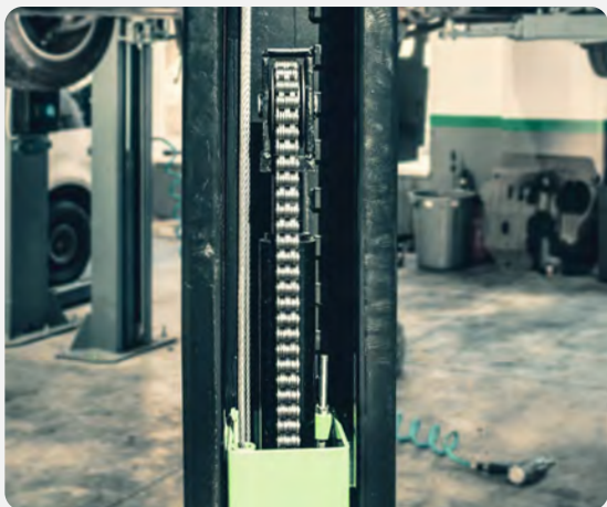
Sistema de seguridad de trabas mecánicas
